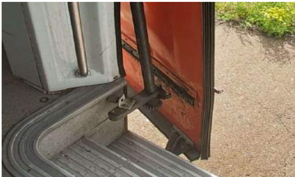
Foto nr.9 Bară stabilizatoare deformată și sărita de pe șina de ghidare la partea inferioară a ușii ca urmare a lovirii contragreutății stâlpului
