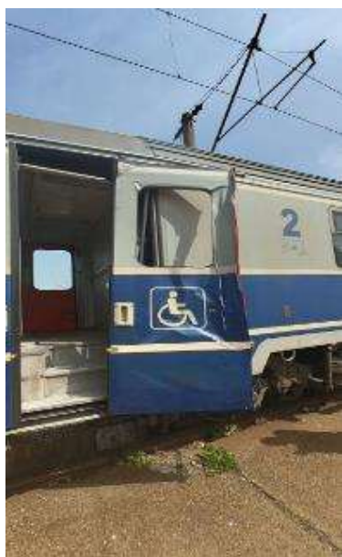
Foto nr.13 Fața exterioară ușă acces vagon deformată
