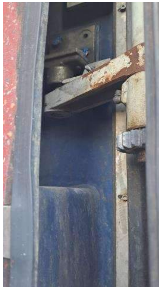
Foto nr.11 Poziția corespunzătoare a pivotului barei stabilizatoare la partea inferioară a ușii
