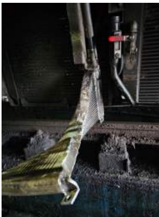
Foto nr.5 : Radiator răcire ulei hidrostat MD1 desprins din prinderi
