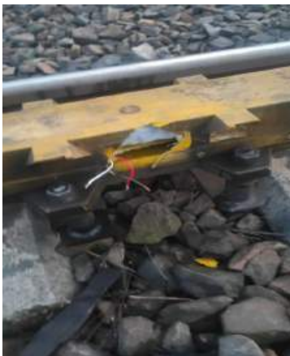
Foto nr.3: Inductor de 500Hz aferent semnalului de intrare X al stației CFR Găești, având seria 194644/02
