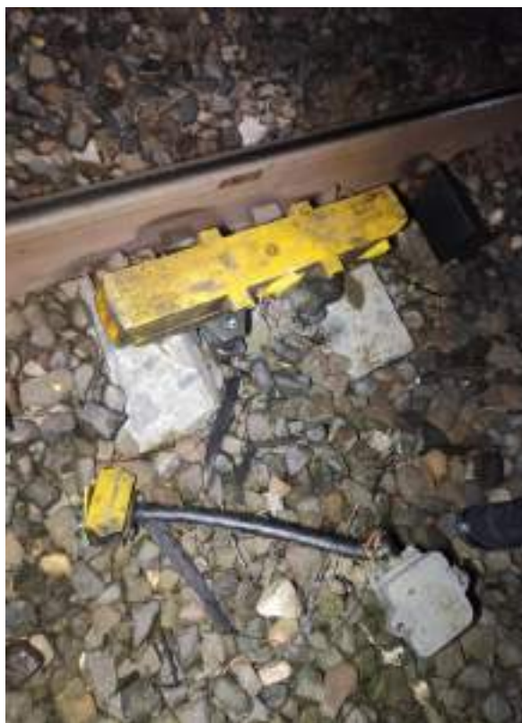
Foto nr.2: Inductor de 1000/2000 Hz aferent semnalului de intrare X al stației CFR Găești, având seria 345240/03
