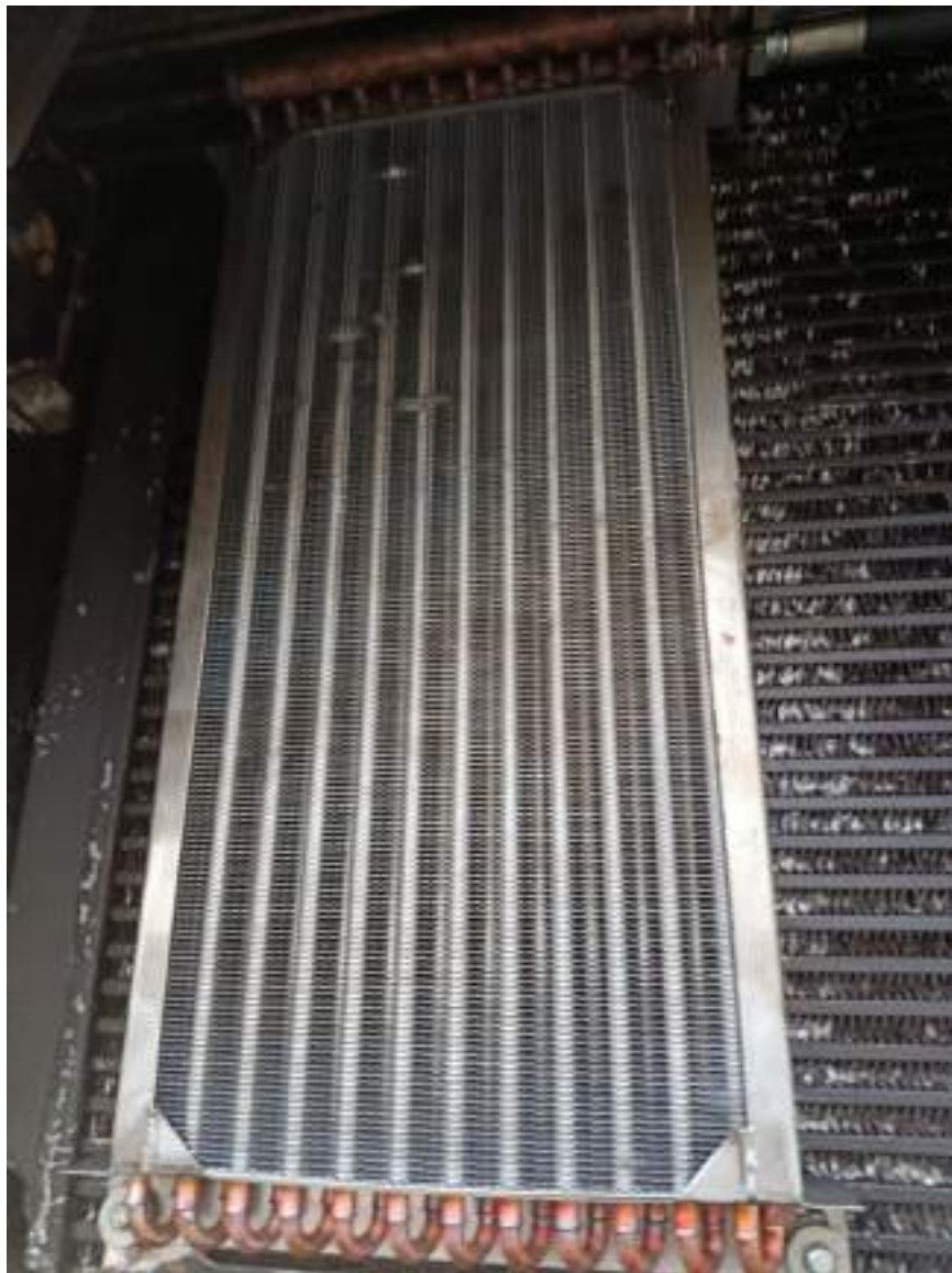
Foto nr. 8: Mod prindere radiator răcire ulei hidrostatisat
