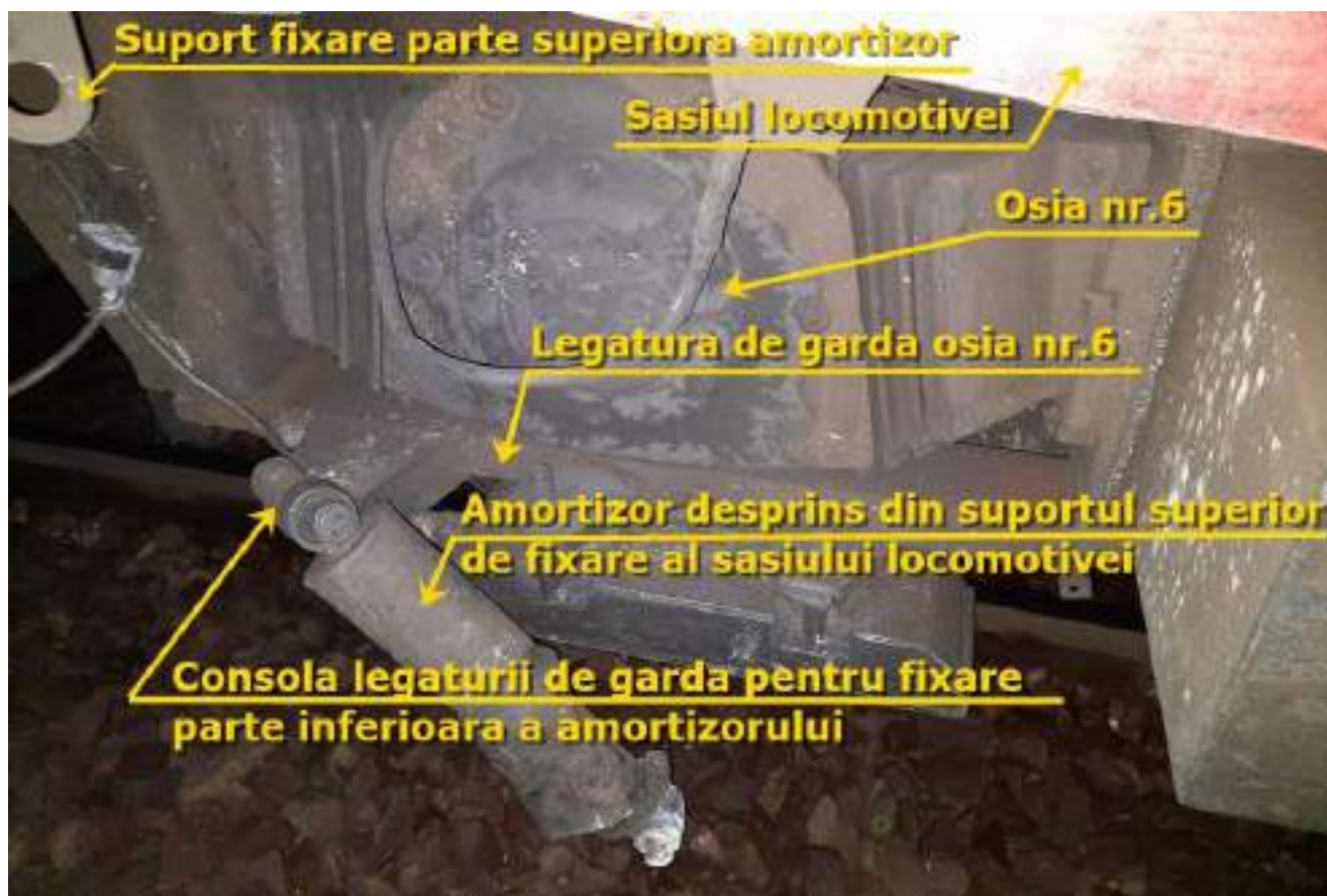
Foto nr.1 Amortizorul desprins din suportul superior
