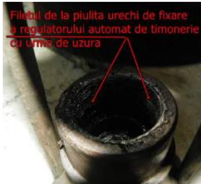
Foto nr.8 Filetul interior al piuliței urechii de fixare pe pârghia de transmisie.
