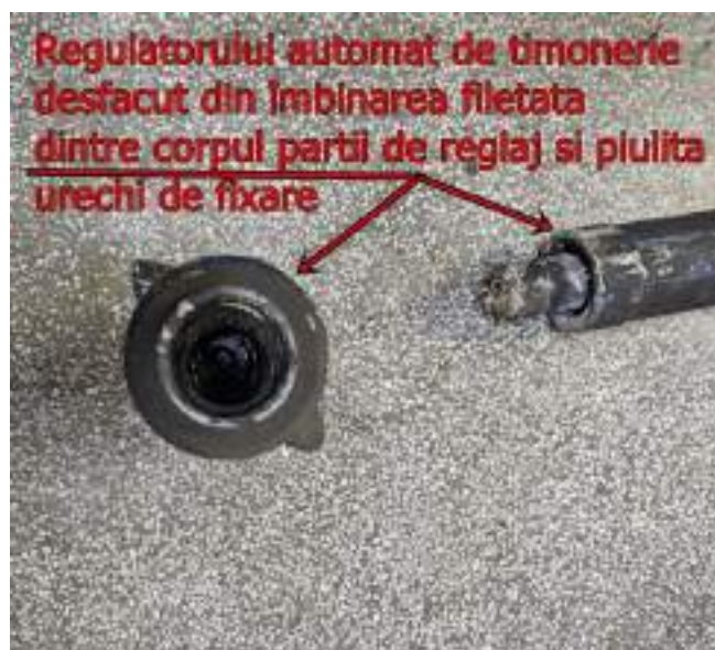
Foto nr.5 Regulatorul automat de timonerie desfacut din îmbinarea filetată
