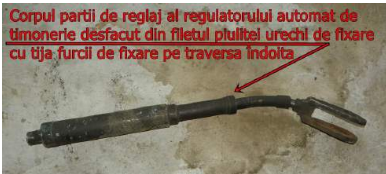
Foto nr.6 Corpul părții de reglaj al regulatorului automat de timonerie tip RL 2 – 350.
