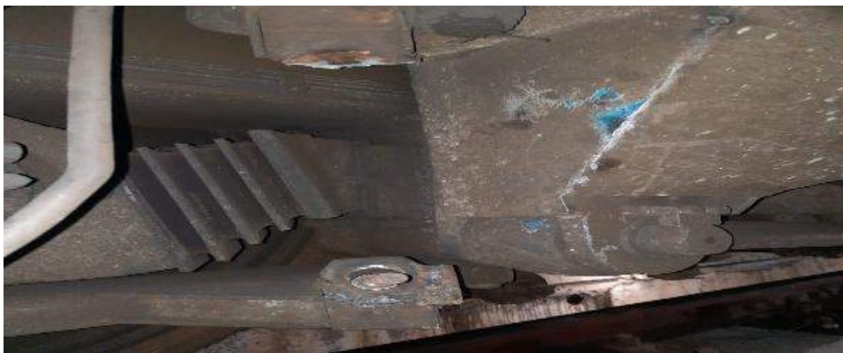
Foto 7. Suportul de prindere de pe cutia locomotivei
