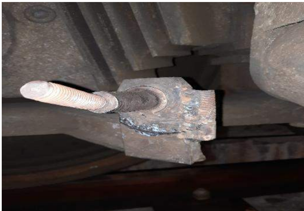
Foto 10 Partea mobilă a amortizorului cu porțiunea de asigurare a bolțului de prindere
