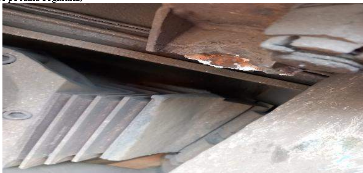
Foto 9 Ruptura în suportul de fixare a amortizorului vertical
