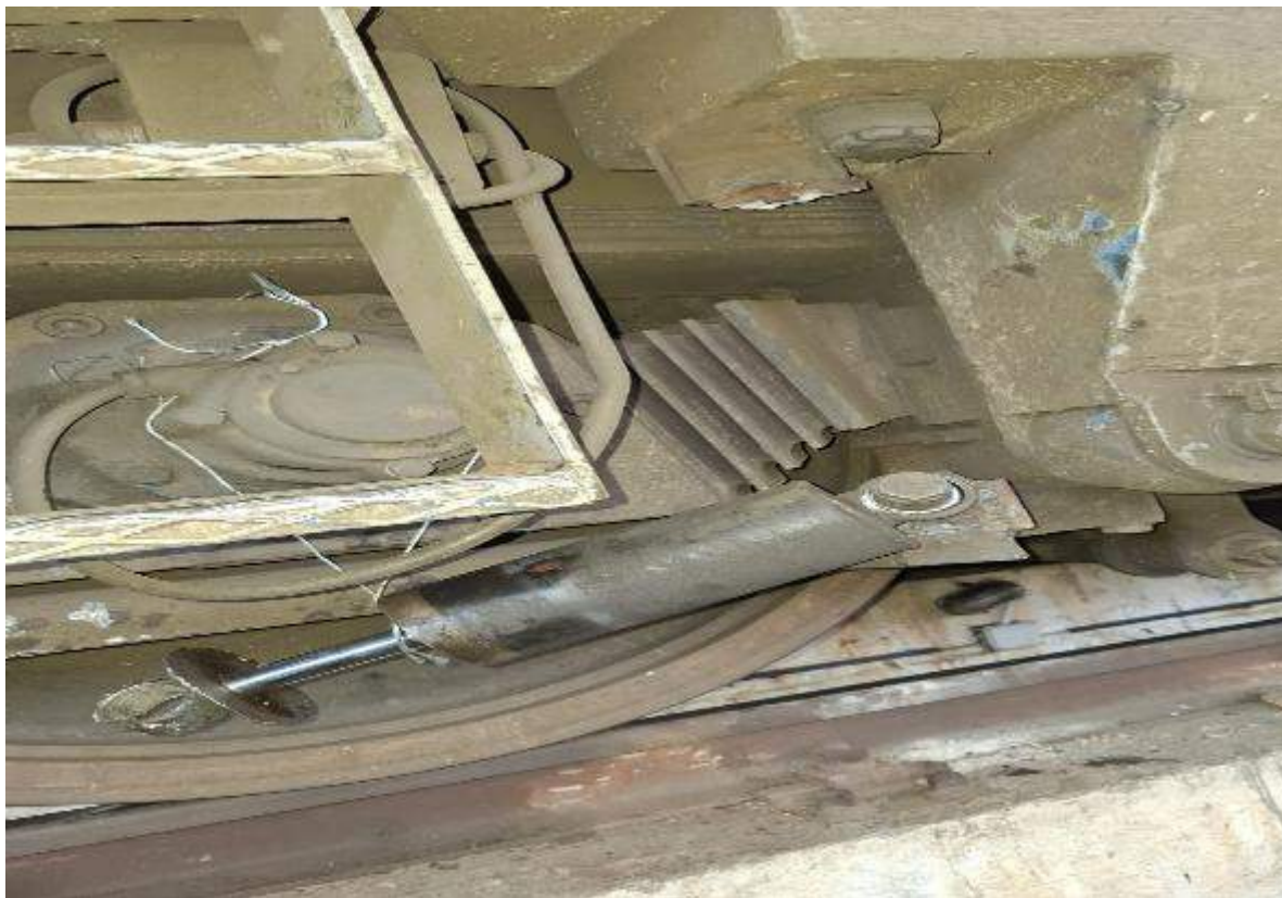
Foto 6. Modul de asigurare a telescopului la sosirea în Revizia de vagoane Craiova
