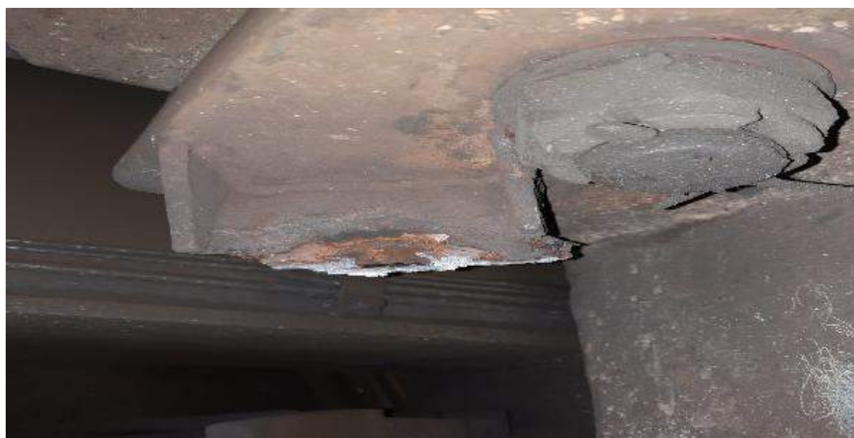
Foto 8. Zona de rupere de pe cutia locomotivei
