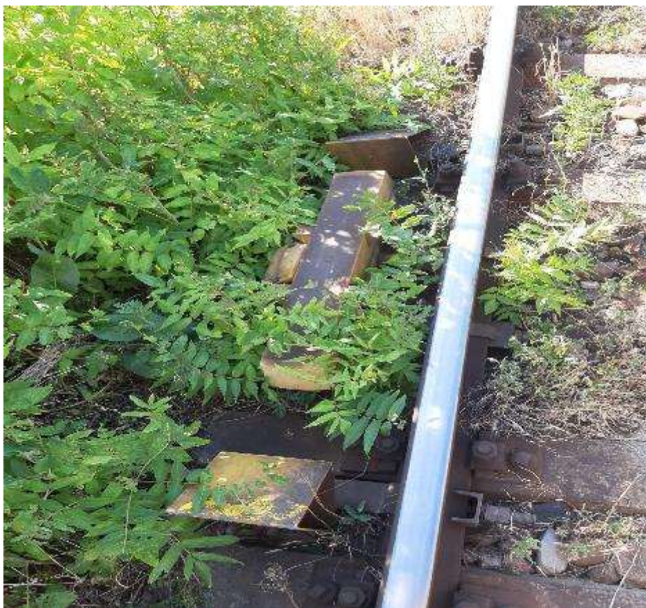
Foto nr.3: Inductor de 500 Hz aferent semnalului YPF
