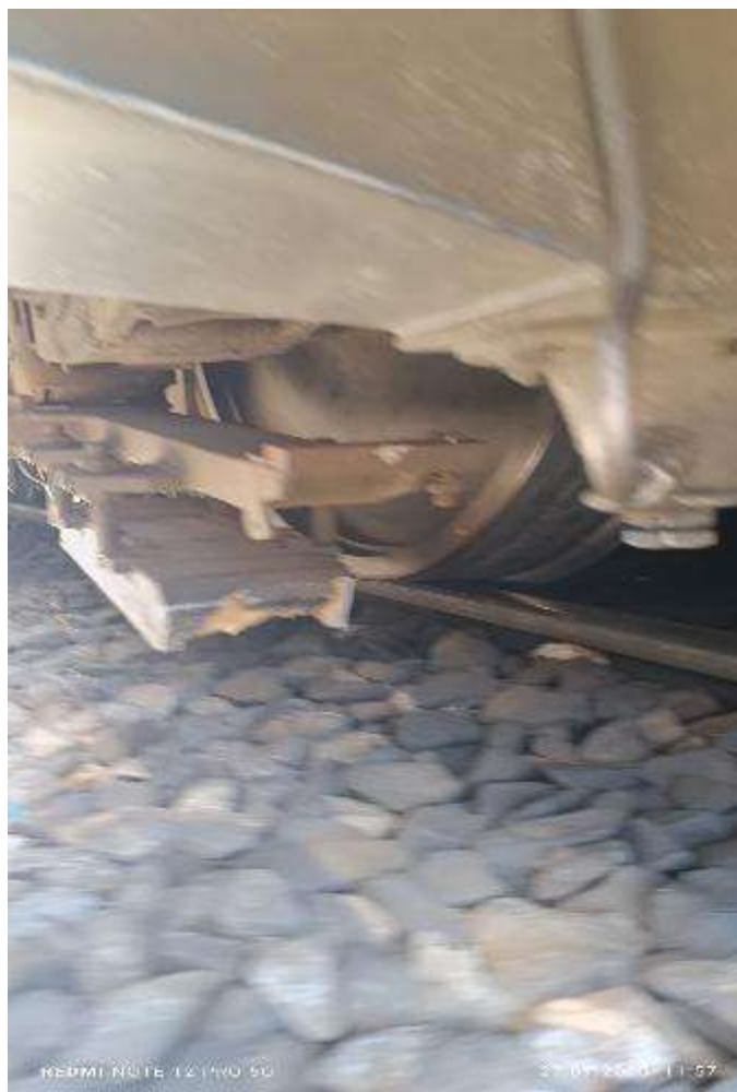
Foto nr.1: Legătura de gardă și parte din inductorul aferent de pe locomotiva EA 131
