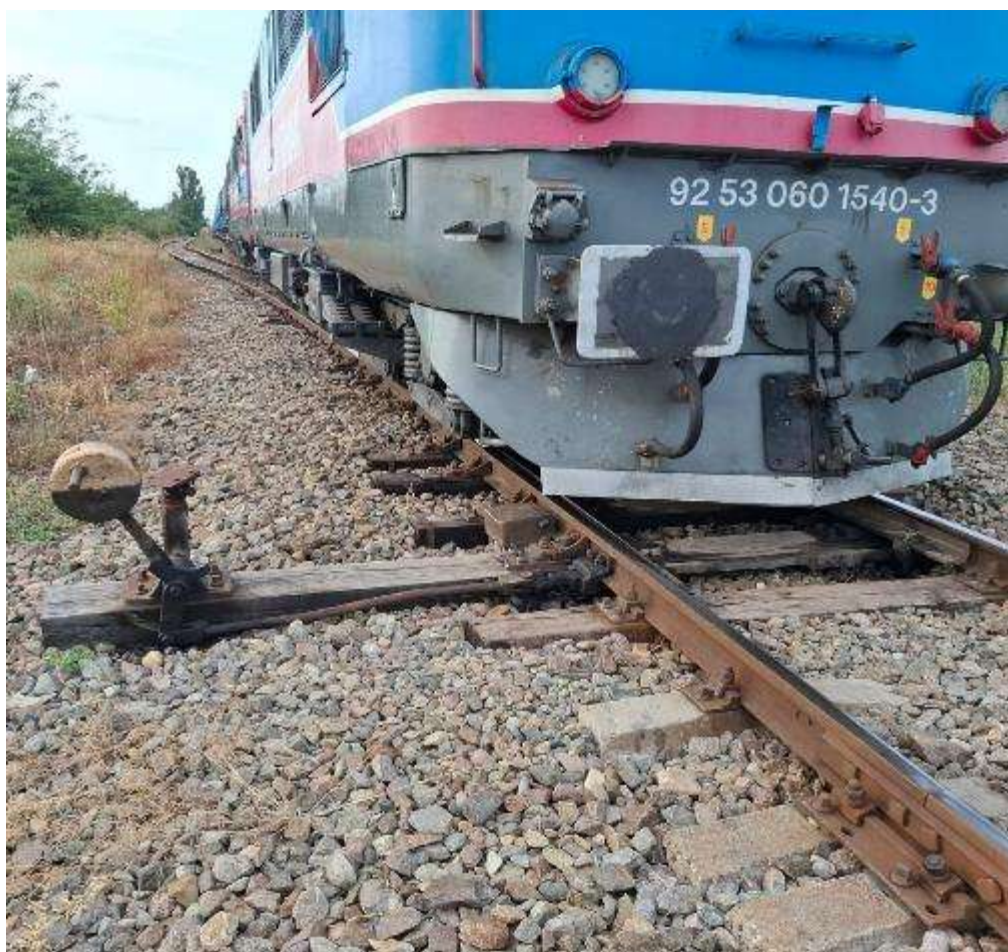
Foto nr.1 – locul opririi trenului cu depășirea mărcii de siguranță și talonarea macazului nr.3
