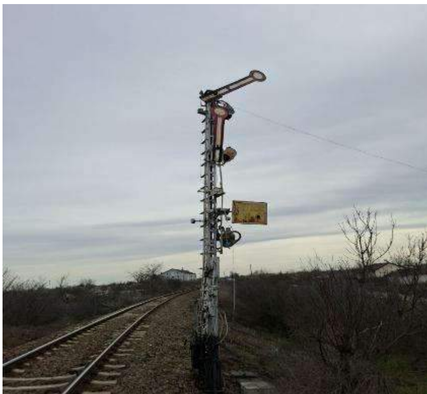
Foto nr.3 Semaforul de intrare D1/2, al stației CFR Vlădueni, în poziție pe liber la directă cu paletă galbenă.
