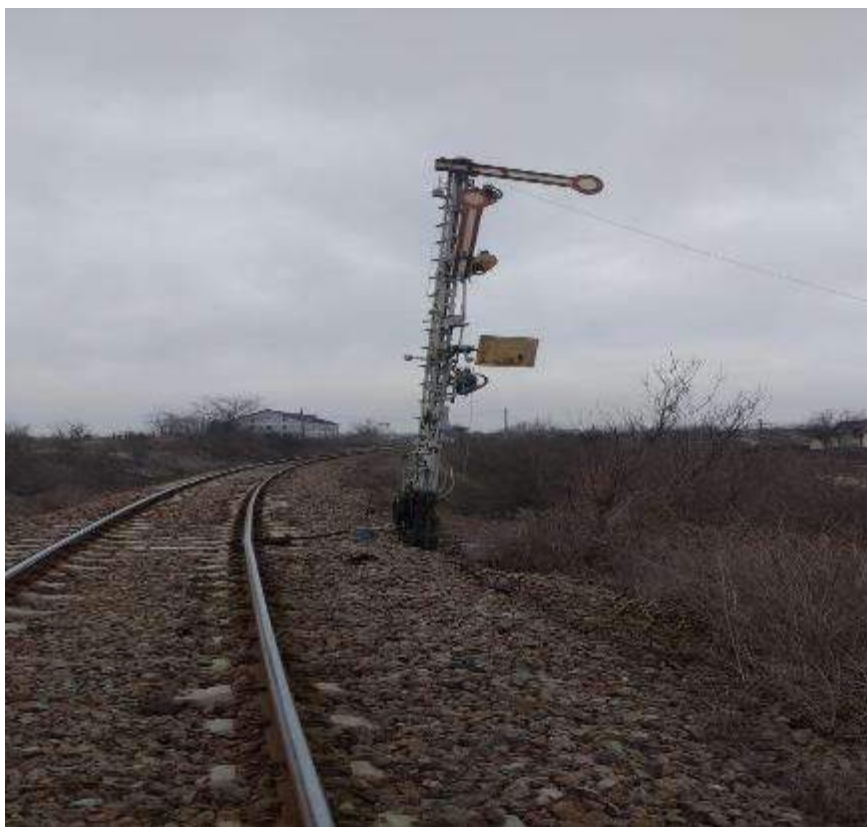
Foto nr.2 Semaforul de intrare D1/2, al stației CFR Vlăduțeni, în poziție pe oprire cu intrare la linie directă
