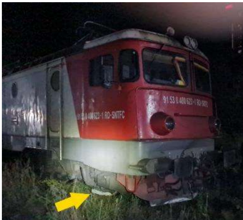
Imaginea nr.4 – Imagine cu inductorul lovit al locomotivei
