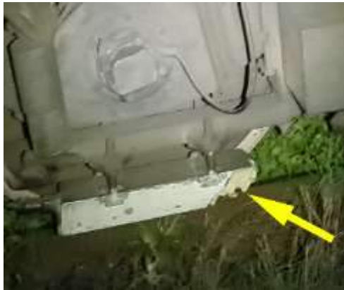
Imaginea nr. 7 – inductorul locomotivei era spart
