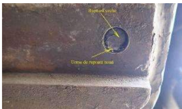
Foto nr.6 Șurub din suportul de fixare a legăturii de gardă cu urme de ruptură nouă 10%
