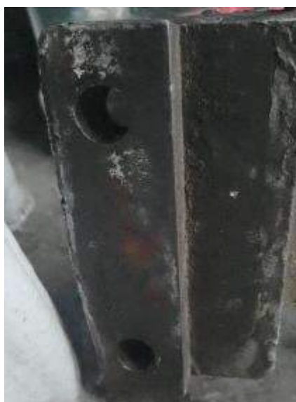
Foto nr.5 Găurile din legătura de gardă, capătul dinspre postul nr.2, cu urme de lucru
