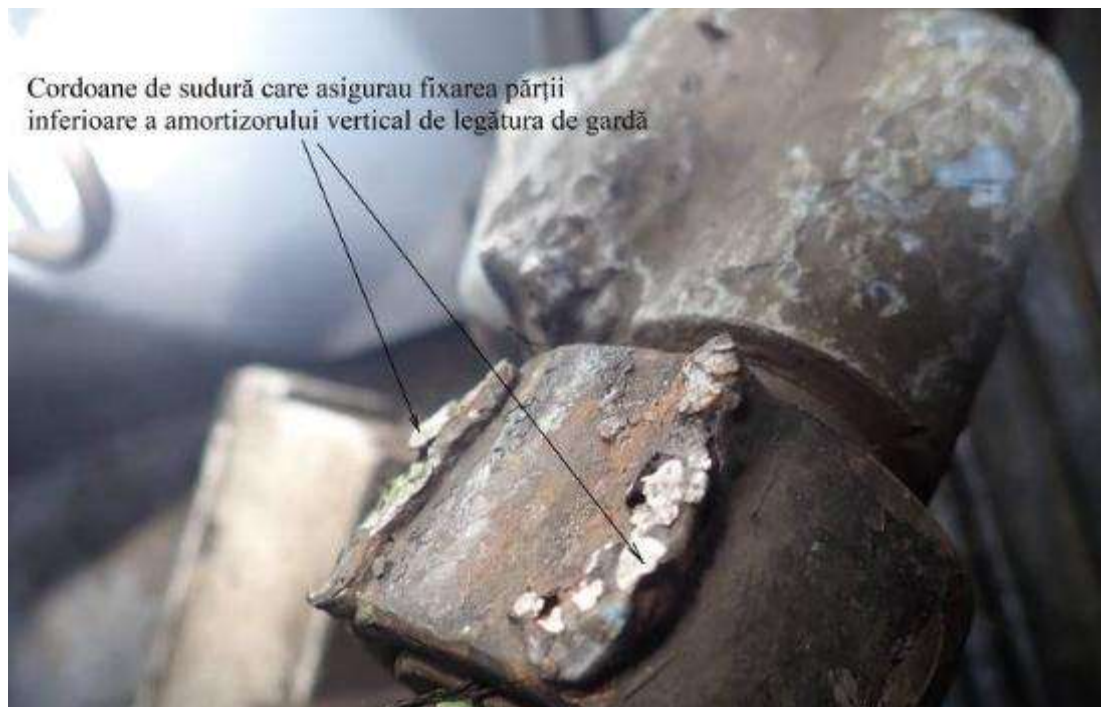
Foto nr.7 Urme de ruptură nouă 15% în zona de fixare a părții inferioare a amortizorului vertical de legătura de gardă cu ruptură
