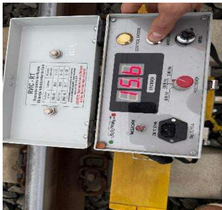
Foto nr.3 Influența de 2000Hz a inductorului de cale aferent semnalului de intrare YA
