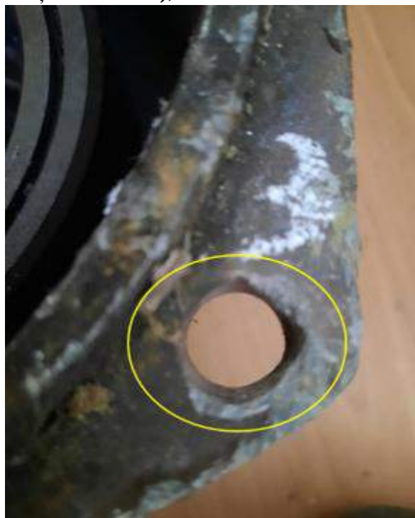
Foto nr.11 Gaură de fixare ovalizată a dispozitivului antipatinaj
