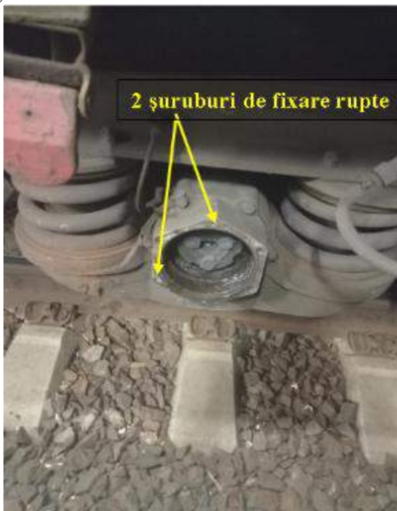
Foto nr.9 Dispozitiv antipatinaj lipsă la roata nr.2
