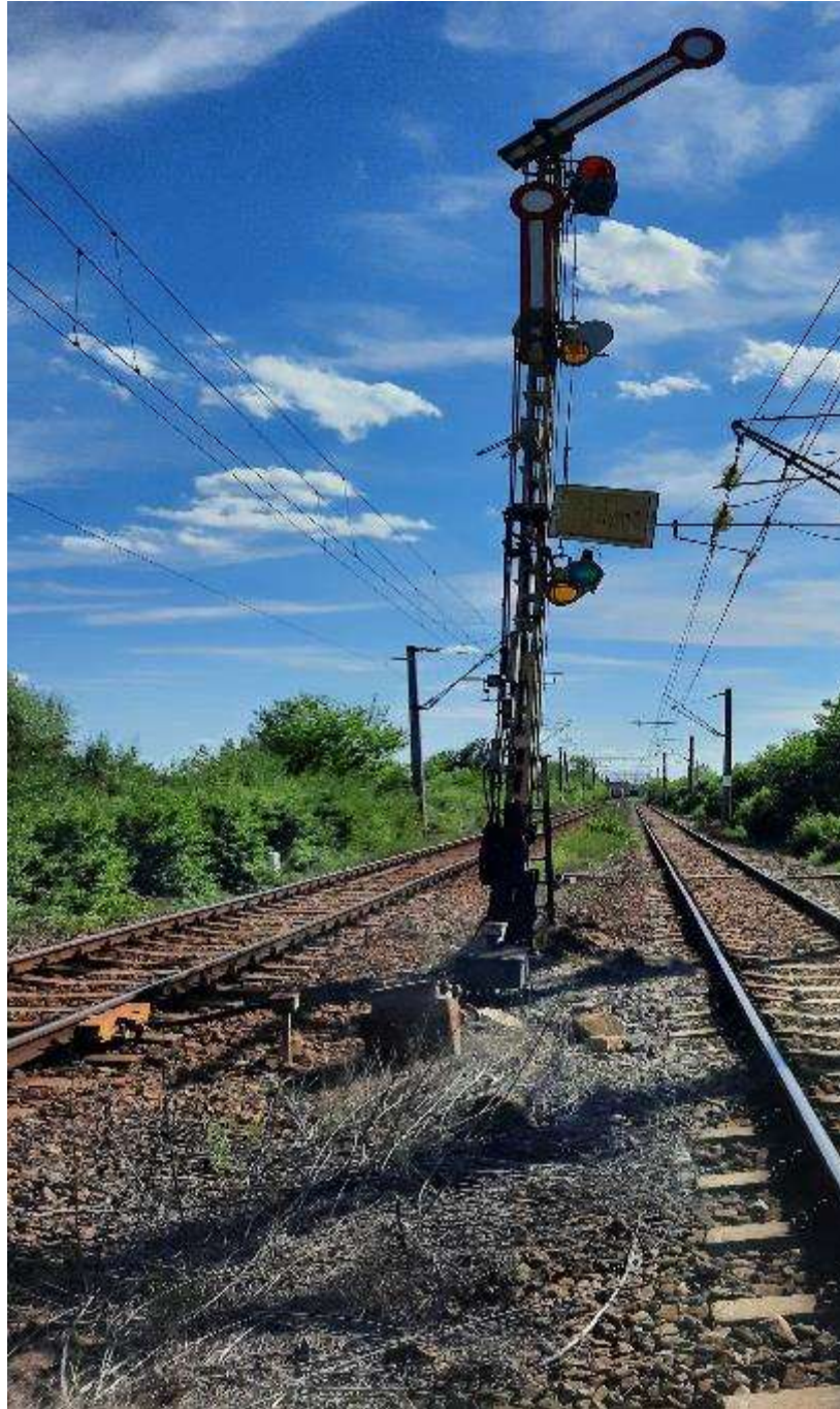
Foto nr.1 Poziția și indicația semaforului de intrare, al stației CFR Amaradia, înainte de producerea incidentului „ Liber pe linia directă, cu viteză stabilită. ATENȚIE! Semaforul de ieșire sau semaforul de parcurs ordonă oprirea. ” Ziua—brațul de sus ridicat la 45^\circ spre dreapta sensului de mers, iar paleta prevestitoare a semaforului de ieșire cu fața galbenă spre tren
