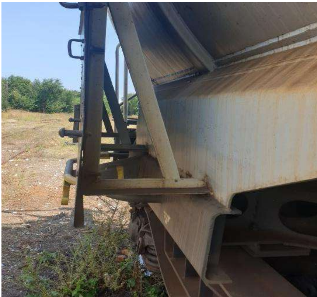
Foto nr.9 - mod de prindere de șasiu a tablei indicatoare
