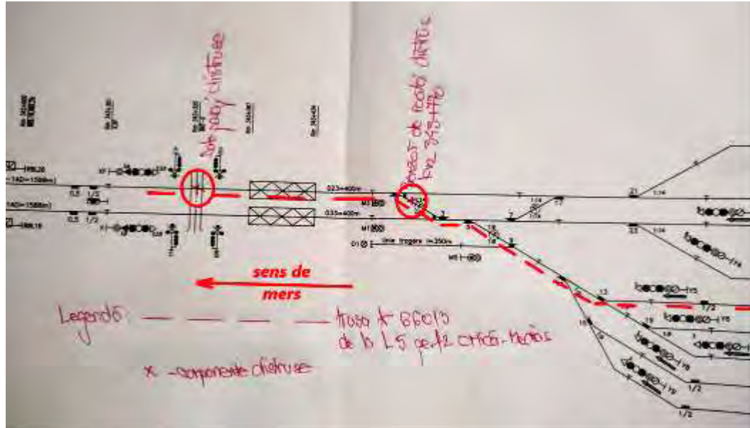
Figura nr.2 – traseul trenului și poziționarea instalațiilor lovite
