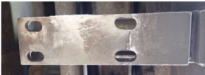
Foto nr. 3 Suport orizontal fixare inductor (partea din față) post I
