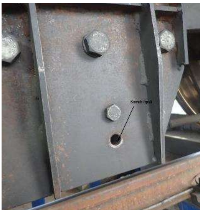
Foto nr. 2 Suport vertical fixare inductor post I
