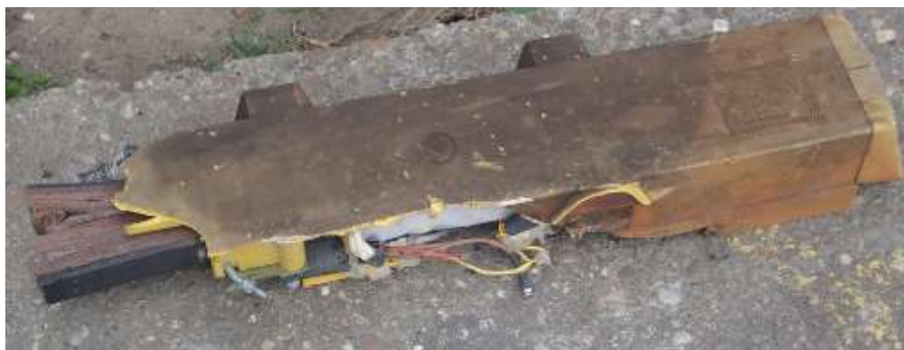
Foto nr.1 Inductorul de 500 Hz al semnalului BL 11
