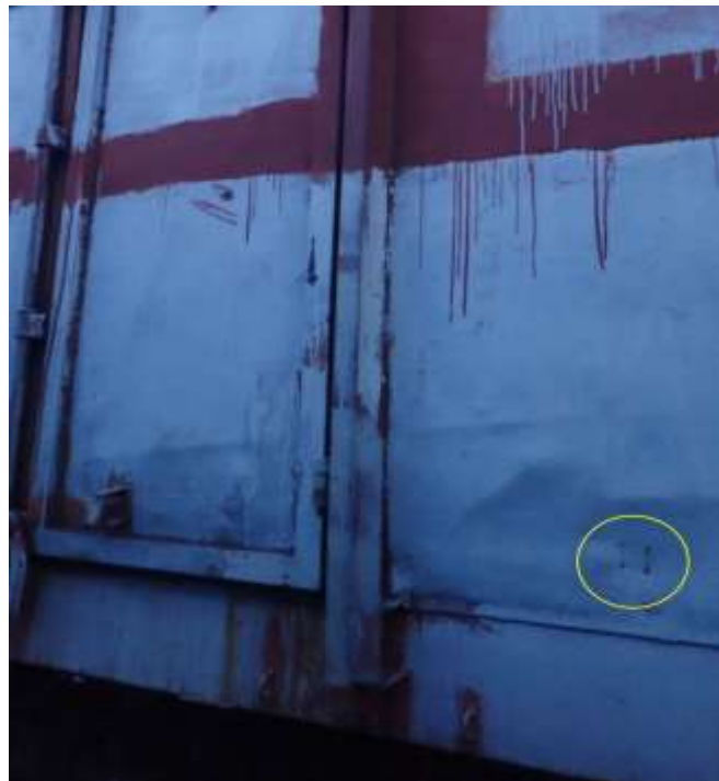
Foto nr.8 Urmă produsă prin lovirea cutiei de suportul de fixare a levierului axului central
