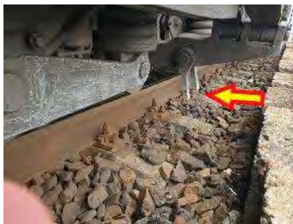
Imaginea 8 – brațele rupte ale bridei pendulare, cu capătul rotit în jos spre terasament
