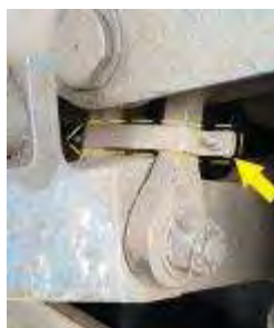
Imaginea 12 – colier de siguranță aplicată pe brida pendulară (model)
