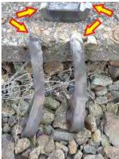
Imaginea 7 – cele două secțiuni de rupere ale bridei pendulare
