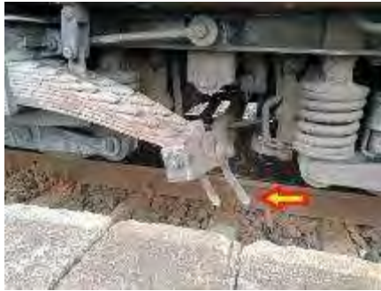
Imaginea 9 – ca urmare a lovirii elementelor infrastructurii feroviare, brațele de la brida pendulară erau îndoite
