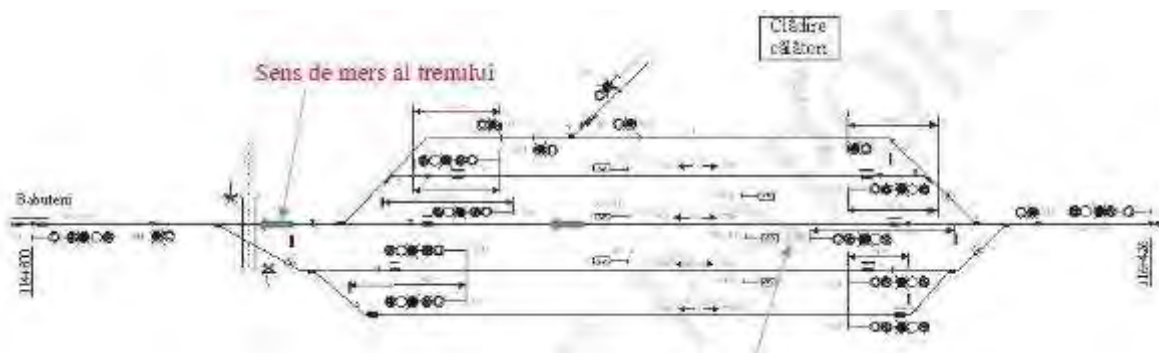
Imaginea 3 - Amplasamentul primului inductor avariata, în raport cu sensul de mers, la semnalul de ieșire X III din Hm. Surduc Sălaj
