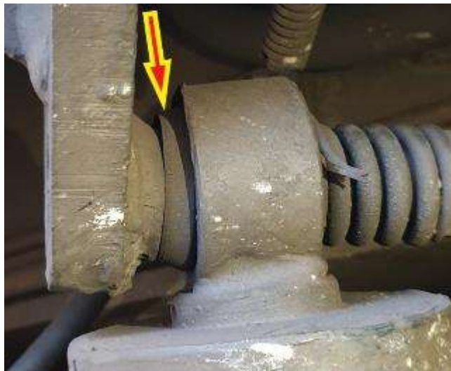
Imaginea 8 – exemplu de garnitură de cauciuc la bulonul de fixare superior
