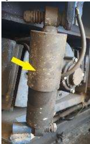
Imaginea 5 – exemplu de amortizor hidraulic vertical montat
