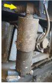
Imaginea 6 – exemplu de bulon de fixare superior
