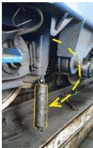
Imaginea 11 – amortizorul hidraulic s-a rotit înspre inductorii din cale (exemplu)
