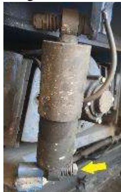
Imaginea 7 – exemplu de bulon de fixare inferior
