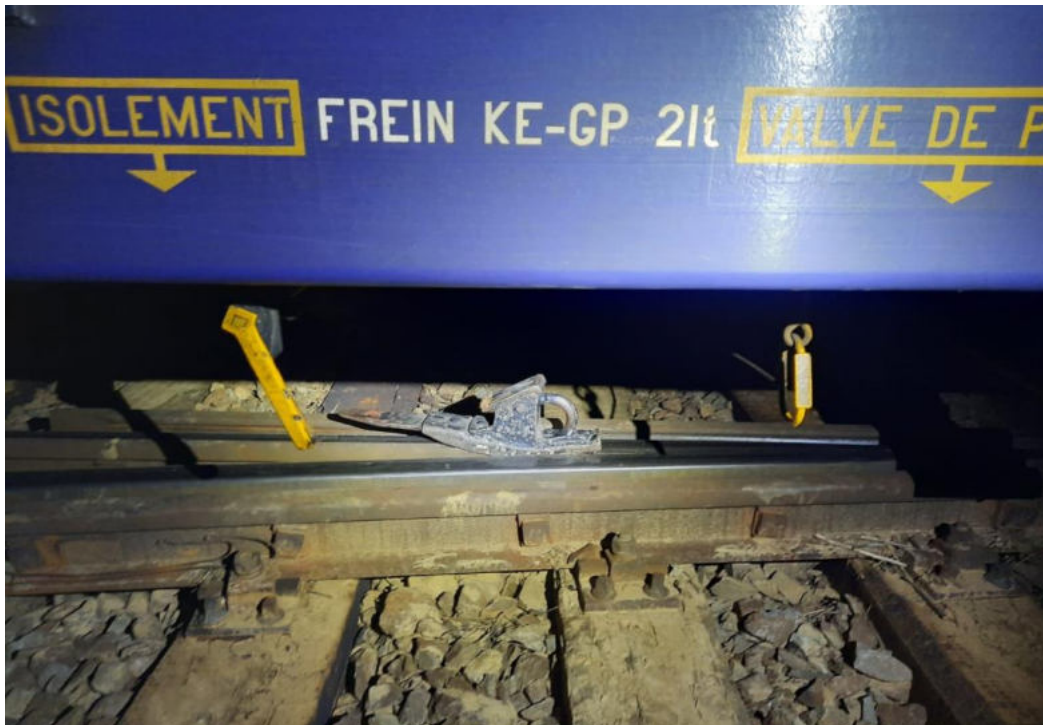
foto nr.3: poziția sabotului de mână după producerea accidentului
