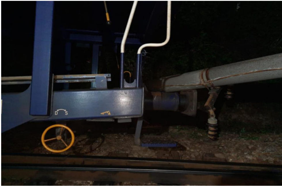
foto nr.2: stâlpul de susținere a LC nr.17 lovit de vagonul deraiat
