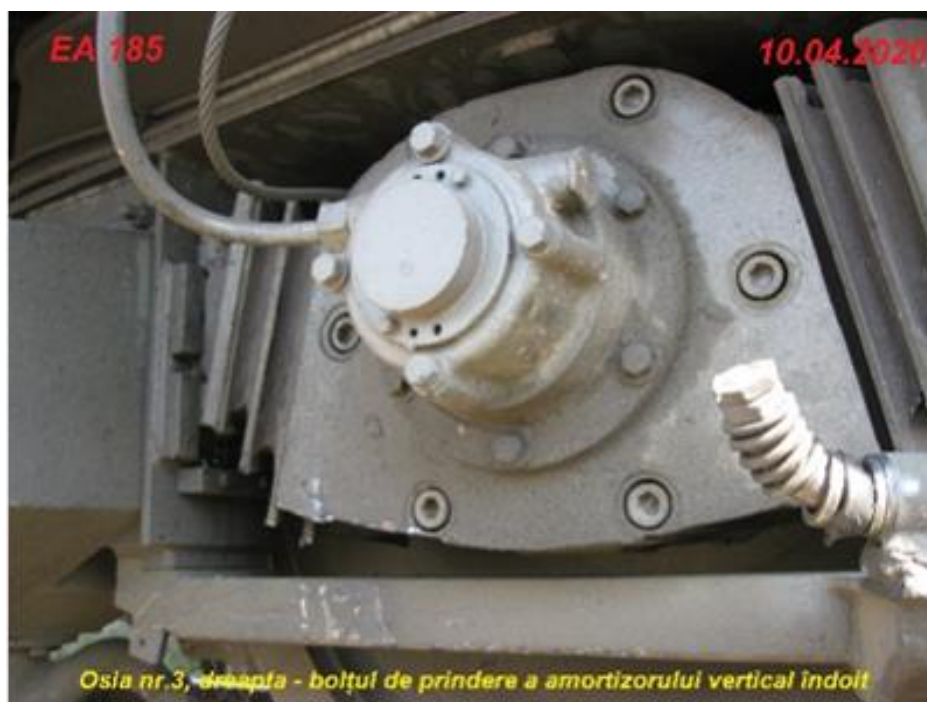
Foto nr.2 - Imagini ale suportului de fixare a amortizorului vertical (urechea) de cutia locomotivei rupt, bolțul de fixare a amortizorului pe legătura de gardă îndoit și urme de lovire recentă a capacului de protecție/gresare al osiei nr.3, dreapta
