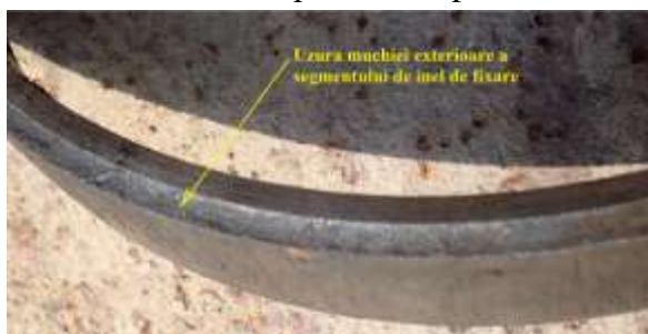
Foto nr.3 Segmentul de inel de fixare care prezenta uzură
