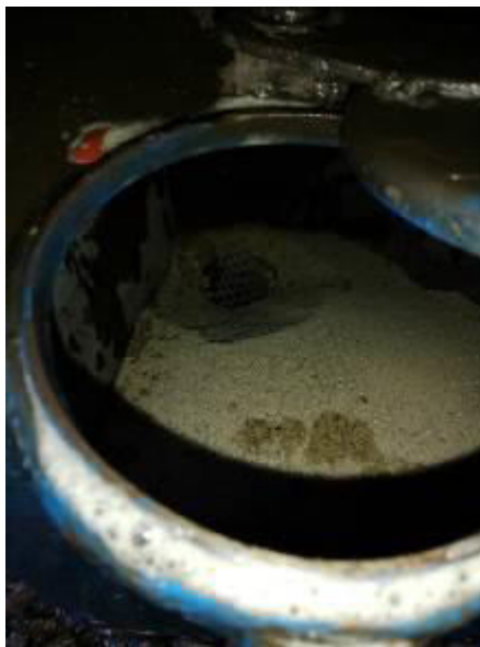
Foto nr.1 și nr.2 - cutiile cu nisip ale locomotivei EA 089
