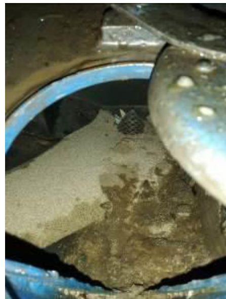
Foto nr.1 și nr.2 - cutiile cu nisip ale locomotivei EA 089
